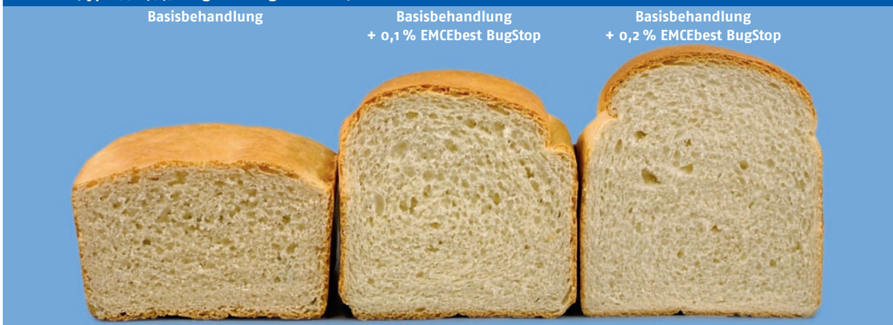
Abb. 1: Backversuche mit EMCEbest BugStop: Volumen und Porenbild von wanzenstichgeschädigtem Mehl (Type 550, 3,5 % geschädigte Körner) lassen sich deutlich verbessern.
